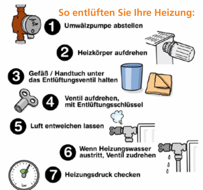
Abbildung 3: Heizung entlüften Schritt für Schritt (Bildquelle: heizsparer.de)
