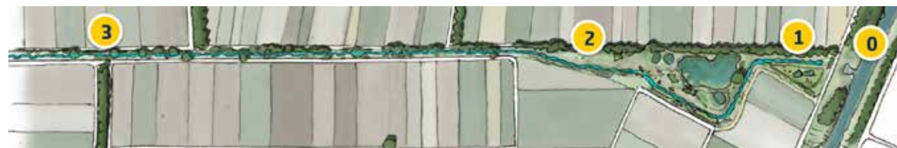
Abb. 1: Neues Fliessgewässer zwischen Unterwasserkanal (0) und Donnerloch (3) mit grosszügiger Aufweitung (1) und Ausgleichsmassnahmen Hurni AG (2)
